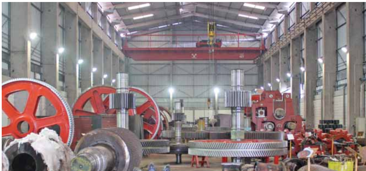
O equipamento (em vermelho, acima) é usado para movimentar peças pesadas de usinagem, que podem chegar a 40 toneladas
